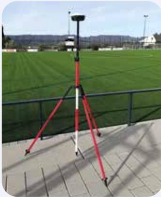
wird. Es ist wichtig, dass die Antenne später jedes Mal genau an der gleichen Stelle angebracht wird, da sonst die Linien auf dem Fussballfeld versetzt oder schief gezogen werden könnten.
